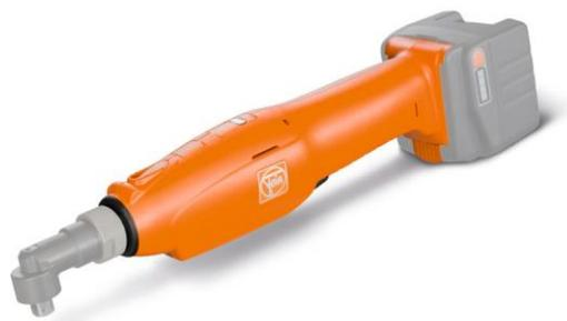
**Нормируемый гайко-винтоверт в соответствии с ISO 5393, VDI/VDE 2647, значение СМК > 1,67 при  $\pm 10\%$  (при 6 сигма).**
