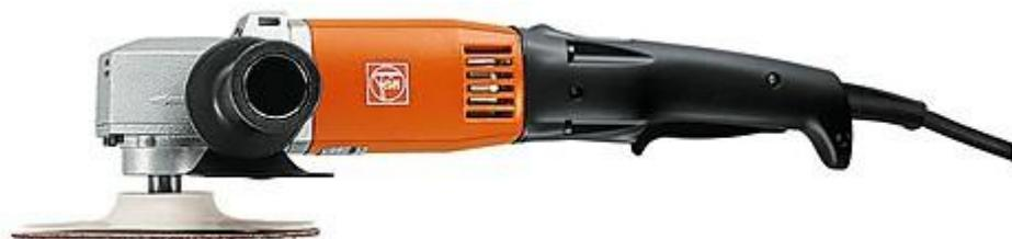
Мощная высокочастотная угловая шлифовальная машина для сатинирования и полирования нержавеющей стали. На шлифмашину устанавливаются диски диаметром 180 мм, мощность электродвигателя 1500 Вт, напряжение питания 200 В 300 Гц, небольшая частота вращения 4400 об/мин.
